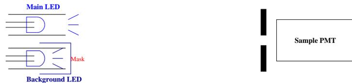
図 3.41: Background LED のレート依存性の測定のセットアップの概念図。Background LED は発光しているが、PMTに光が入らないよう黒紙で覆われている。PMTには基準光源である Main LED からの光だけが入る。
