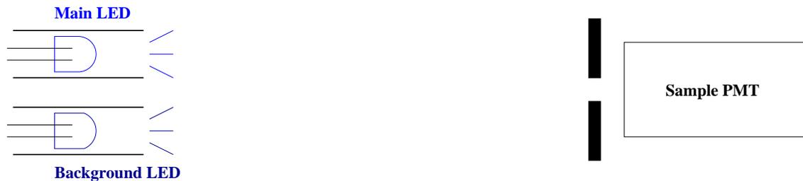
図 3.37: レート耐性測定のセットアップ
