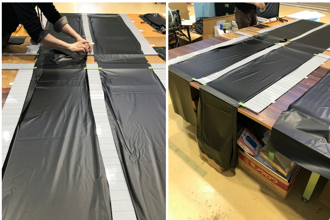
図 6.9: ブラックシートの接着. 養生テープで仮止めし (左), 固定具の各空間に合うようにコーキングボンドで固定した (右).
