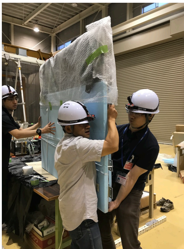
図 7.1: NA から B2 へのトラック運搬。梱包材を用いてトラックを保護し作業を行った。
