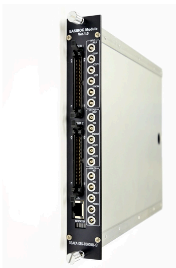
図 4.12: EASIROC NIM モジュールの外観 [54].
