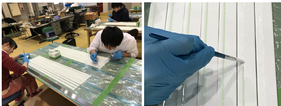
図 6.4: 反射材塗布. 1 スロットで一人 10 本程度 (左), ファイバーが接着された溝の上を中心に塗布していく (右).
