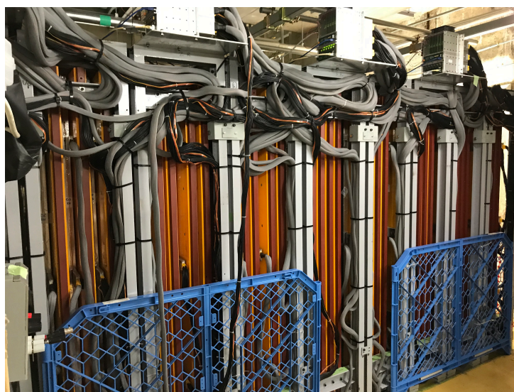
図 3.13: Baby MIND の外観。銀色の部分が detector module, オレンジ色の部分が magnet module である。
