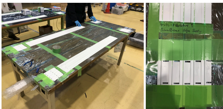
図 6.3: ファイバー接着用セットアップ (左)。WAGASCI モジュールのグリッド用シンチレータがジグとして使用されている (右)。
