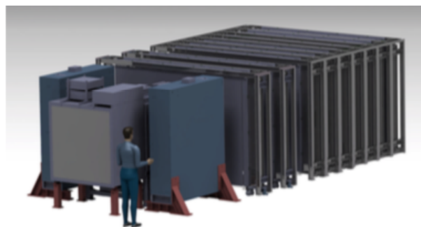
図 2.8: WAGASCI 実験. J-PARC のニュートリノ前置検出器ホールの B2 フロアに 4 種類の検出器がインストールされている.
