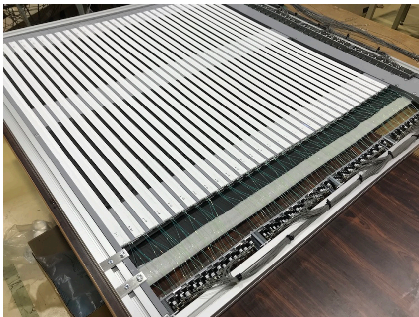
図 6.16: 完成したトラッカー. J-PARC NA 棟の机の上に寝かされた状態である.
