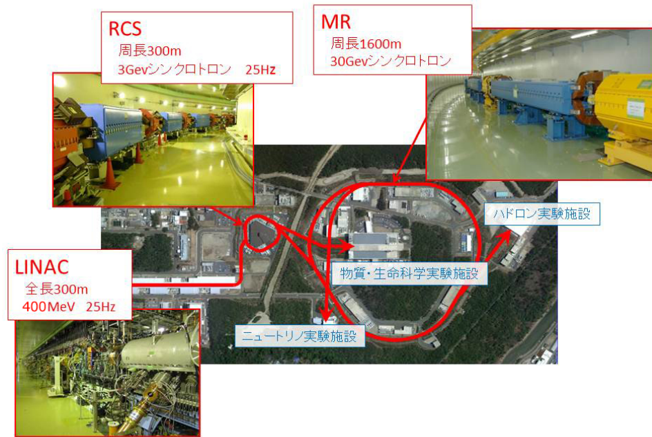
図 2.2: J-PARC の加速器群の概要 [17]. LINAC, RCS, MR の三種類からなり，陽子ビームを 30 GeV まで加速する。
