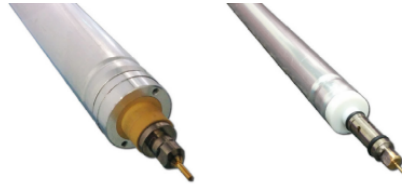
図 2.29 (左) 現行の MDT のチューブ。(右) sMDT のチューブ。 [9] ドリフトチューブの径が小さくなり、ドリフト時間が小さくなる。
