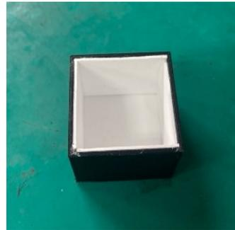
図 6.4: 反射シートを用いた WbLS セル (RS)
