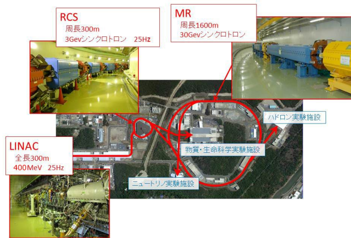
図 2.2: J-PARC の加速器 [22]. LINAC, RCS, MR の 3 台から構成されており、陽子ビームを 30 GeV まで加速する。
