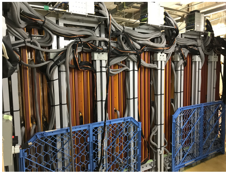
図 4.7: Baby MIND の外観. オレンジ色の部分が magnet module である. detector module ははっきりと見えにくい, magnet module の間にある.
