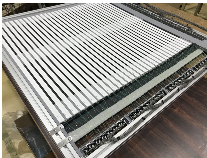
図 4.9: 過去の物理ラン A, B で用いたシンチレーショントラッカーの外観。
