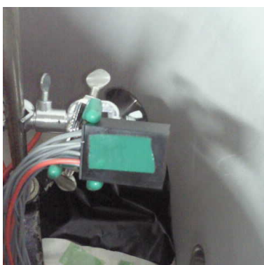
図 5.11: H6568-10 真空試験 setup。真空槽の中にスタンドを設置し、PMT を固定した。
