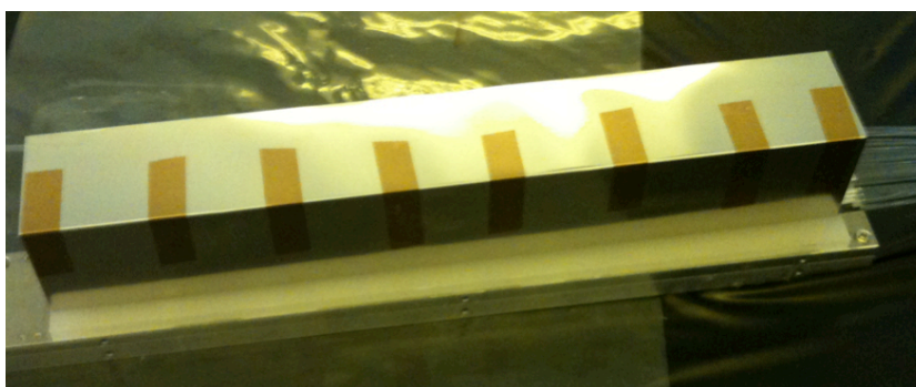
図 4.16: SUS を巻き、完成した module
