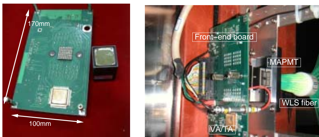
Figure 6.20: 開発したフロントエンドボード。サイズは170mm × 100mm。TQFPパッケージのVA/TAを両面に実装し、マルチアノード出力のアナログラインに鏡面对称性を持たせてある。また写真右は2003年1月に実機にインストールされたもの。
