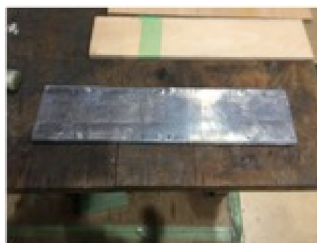
図 6.2 使用した鉛プレート。1 枚 1.6 mm 厚のものを 6 枚重ねて使用した。
