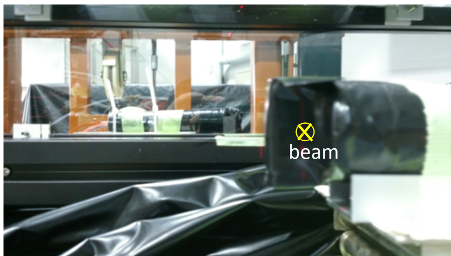
図 4.5 アクリルとトリガーシンチの様子。紙面手前から奥の方向にビームが照射される。
