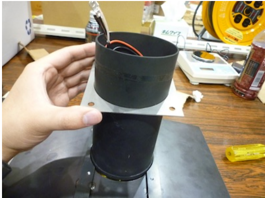
(3) 手順3: ミューメタルをかぶせ、PMT 接合部品2を通す。
