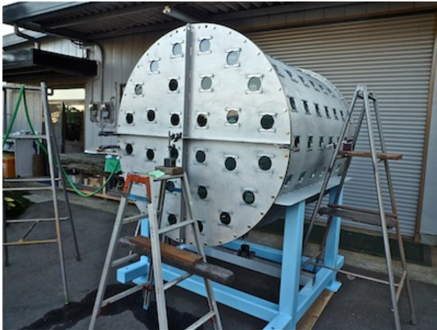
図 5.38: 外タンク水漏れ試験の様子。タンク製作現場にてタンク内を満水にし、水漏れする箇所がないか確認した。水はタンク上部から注水した。タンク前、両横、下にはマイクロメータを設置し、変形量を確認した。
