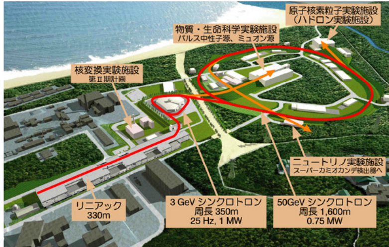
図 2.2: J-PARC 加速器の構成。LINAC、RCS、MR で徐々に加速された陽子は最終的に 30 GeV のエネルギーに達する。(図は J-PARC 公式 HP より)
