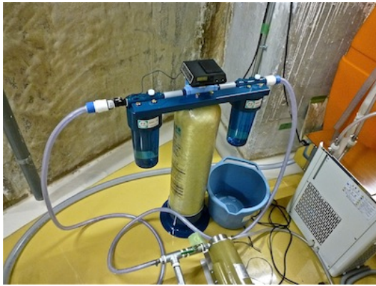
図 5.11: イオン交換樹脂全体。イオン交換樹脂にはオルガノ製純水器 G-10C、前フィルターには FAC-2、後フィルターにはマイクロポア EU タイプを使用する。電気伝導率計を使用して純化を監視しており、電気伝導度が 1\mu\text{S} 以上になるとのアラームが鳴る。水は図の右から左へと流れる。
