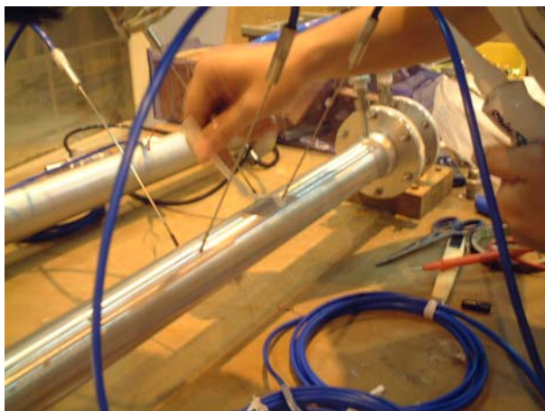
図 5.11: 熱電対の固定の様子
