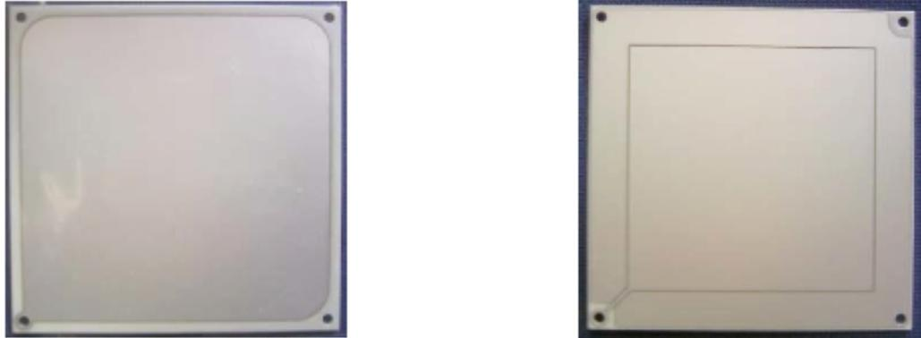
図 3.7: センサーとして使用している電極プレート。左図が電圧をかけるための電極プレートで右図はシグナル用電極プレートである。75 × 75 mm<sup>2</sup> の部分を一様電場部分を有感領域にしている。
