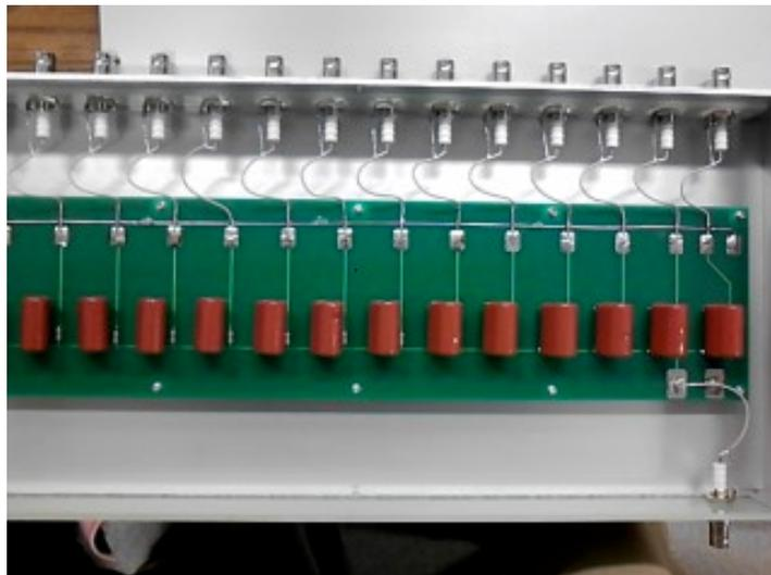
図 5.18: 現在使用している Divider の写真。この回路では 1 ch の入力から 14 ch に分岐出力するように作られている。この回路には  $1\mu\text{F}$  のコンデンサーと  $51\Omega$  の抵抗を用いている。
