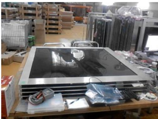
図 4.6: MPPC ノイズ評価におけるセットアップ。写真のように 4 枚のトラッキングプレーンを同じ向きに揃え、重ねて同時に試験を行った。
