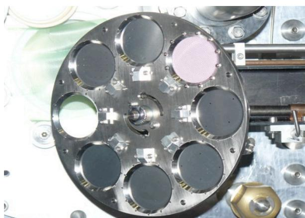
図 2.6: OTR の写真。8 枚のフォイルスロットを有している。
