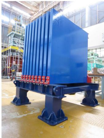
図 4.20: フランスにより制作された鉄の構造体。鉄の隙間にトラッキングプレーンを挿入していく。
