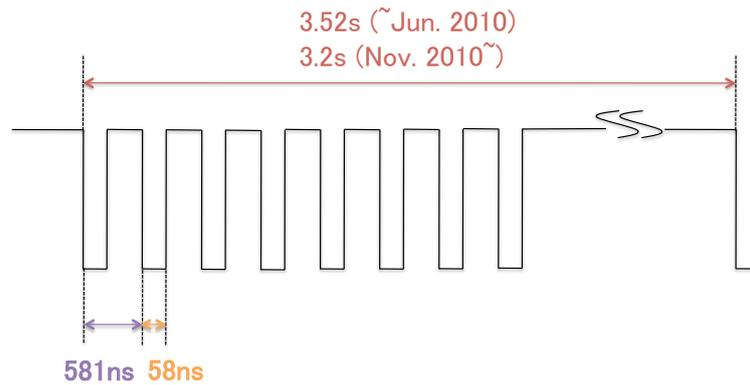
図 2.2: 速い取り出しで取り出されるバンチ構造。スピル周期は 3.2 s(2010 年 6 月までは 3.52 s)であり、1 スピル当たりのバンチ数は 8 バンチ (2010 年 6 月までは 6 バンチ)である。また、バンチ間隔は 581 ns で、バンチ幅は 58 ns となっている。
