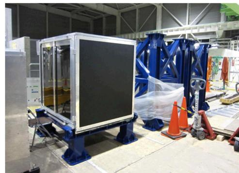
図 4.21: 前置検出器ホールに運び込まれた後の INGRID shoulder module。足場となる構造体も一緒に写っている。
