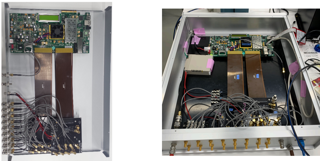
図 5.15 読み出し回路。左と右はそれぞれ一台目 [57] と二台目のものである。写真の上下のボードはそれぞれ FPGA ボードと ADC ボードである。これらの接続には FMC ケーブルで接続している。
