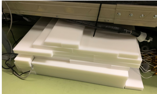
図 C.3 ポリエチレンの熱中性子遮蔽体で覆った読み出し回路
