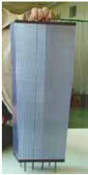
図 2.15: Barrel Photon Veto(BPV):左は鉛とシンチレーターを用いた Shashlyk タイプ検出器のプロトタイプの写真. 右は 1080 の Shashlyk モジュールからなる BPV イメージ. 内径 3.2m, 長さ 4m
