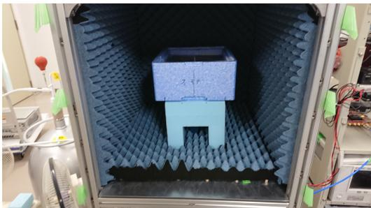
図 5.9: 測定の様子 (77 K)。電波黒体を液体窒素につけ、77 K に冷やした。容器は電波透過率の高い発砲スチロールを用いた。
