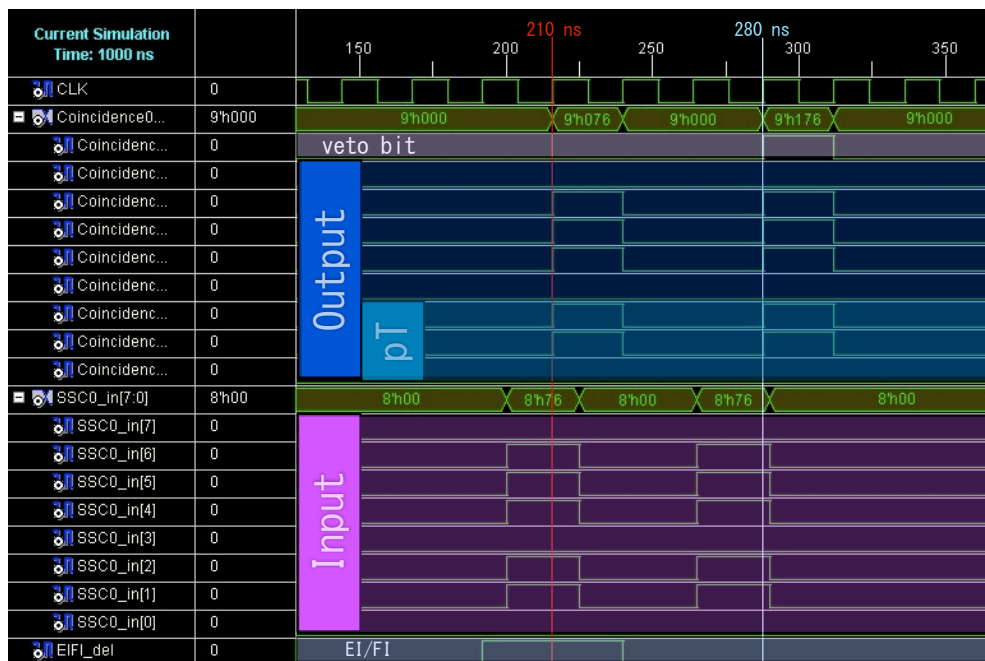
図 6.3 Monitoring mode での回路シミュレーション。EI/FI hit があるトラック (220 nsec 付近) では p_T = 6 のトリガーが出力されており、veto bit の値は 0 である。EI/FI hit のないトラック (300 nsec 付近) では p_T = 6 のトラックが出力されているが、veto bit の値が 1 になっている。
