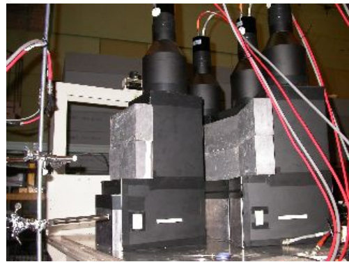
図 6.2: セットアップの写真。上流には 20 mm、下流には 2mm 厚の鉛コンバータが設置されている。シールドには 20 cm \times 10 cm \times 5 cm の規格の鉛ブロックを 2 つ重ねて用いた。
