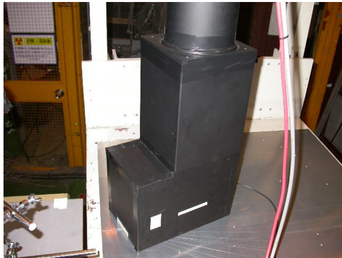
図 5.20: 実際にビーム入射角度を変えたときの写真。架台に乗っているアルミ板のけがきに沿ってモジュールを置く。
