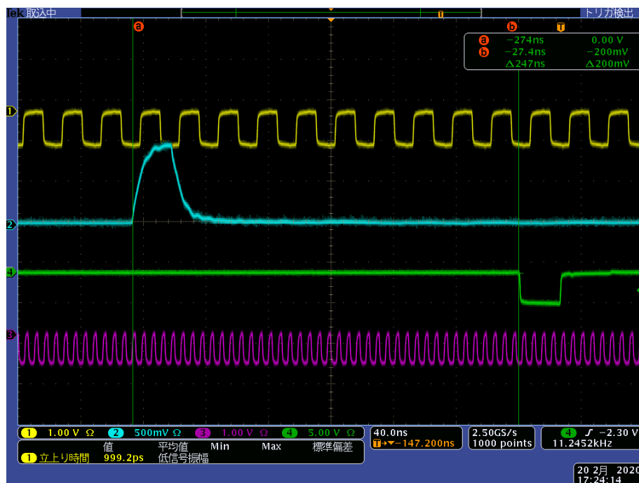
図 6.6 : オシロスコープで得られた波形。青の波形が NSW TP が BCID = 0 の情報を送信したタイミングで、緑の波形は New SL が BCID = 0 の情報を受信したタイミング。この 2 つの信号の時間差から latency の測定を行う。黄の波形は TTC system から受け取る 40 MHz クロックで、紫の波形は New SL 内の 160 MHz クロックである。
