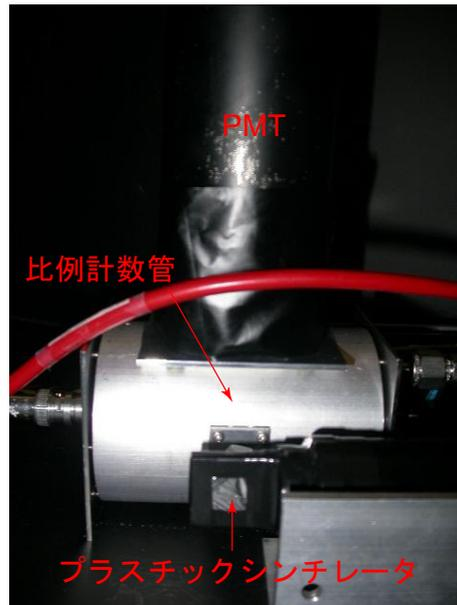
図 3.6: 測定装置の写真。手前に  $^{90}\text{Sr}$  線源が置いてある。
