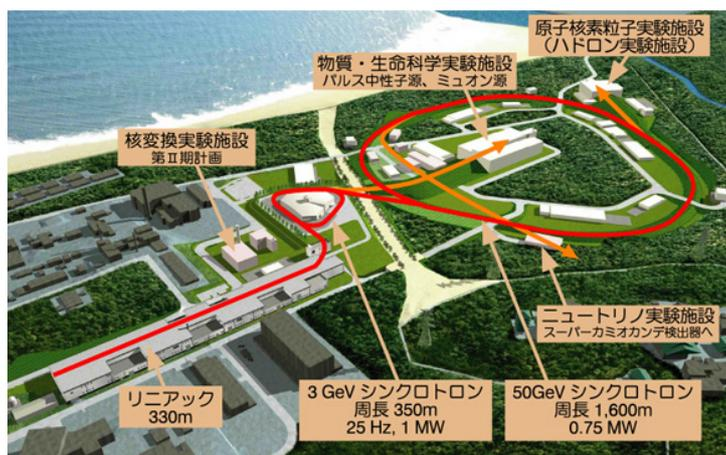
図 2.2 J-PARC ビームライン概略図。LINAC、RCS、MR で徐々に加速された陽子は最終的に 30GeV のエネルギーに達する。
