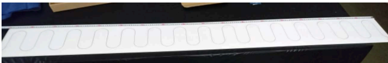
図 3.2.7 Side MRD で使われているシンチレータ。片面に波長変換ファイバー (Kuraray Y-11) を埋め込んである。
