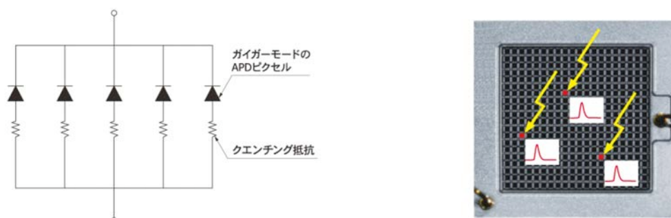
図 4.1.7 MPPC の等価回路 (左) と MPPC のフォトカウンティングのイメージ (右)[36]
