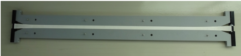
図 3.6: トラッカー全体写真。中央部の白い部分がシンチレーションファイバーで、64本ある。ファイバーのアライメントを固定するために、上下のグレーの固定具とサイドの黒いクッキーではさんである。
