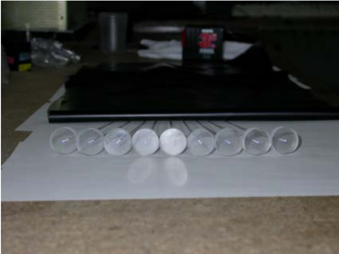
図 2.17: B2(200)M-S 型の端面写真:このうち中央の 5 本に PMT(H8643EGPMOD) がマウントされる
