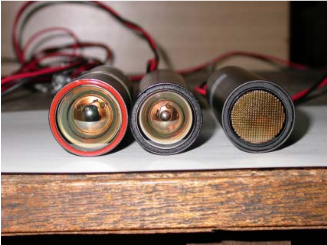
図 2.15: 今回使用した PMT の光電面の写真 (H7415(左)、H8643MOD(中央)、H8643EGPMOD(右))
