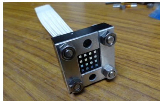
図 7.3.6: ホドスコープシンチレーションファイバーの array 型 MPPC 接続面
