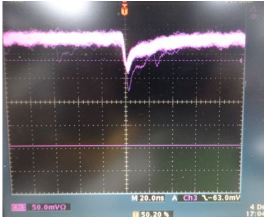
図 5.1.4: 第二世代 MPPC のオシロスコープでの波形。 \Delta V=2.0V .
