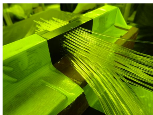
図 8.3.7: 32ch MPPC 用クッキーと波長変換ファイバーの接着の様子。図 8.3.8: 64ch MPPC 用クッキーと波長変換ファイバーの接着の様子。
