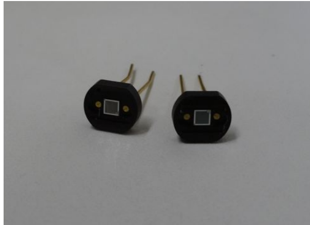
図 5.1.1: 第二世代 MPPC と第一世代 MPPC。左側が第二世代で右側が第一世代である。
