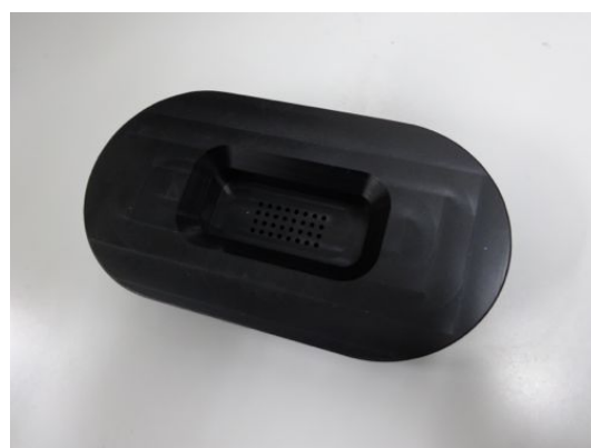
図 8.2.6: 32ch MPPC 用クッキー裏面
