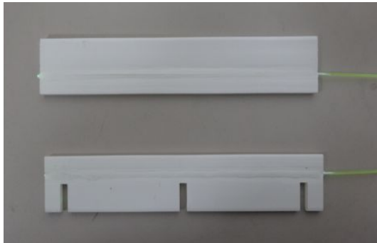
図 7.4.3: Fermi 研究所製薄型シンチレータ 図 7.4.4: 使用した薄型シンチレータの dimension
