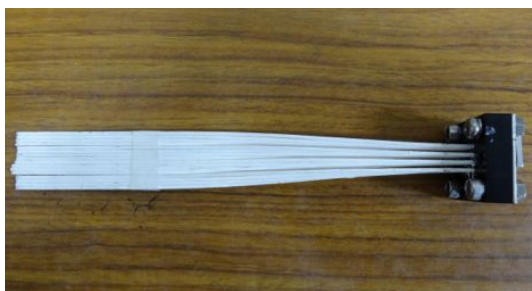
図 7.3.5: ホドスコープに使用したシンチレーションファイバー 16 本
