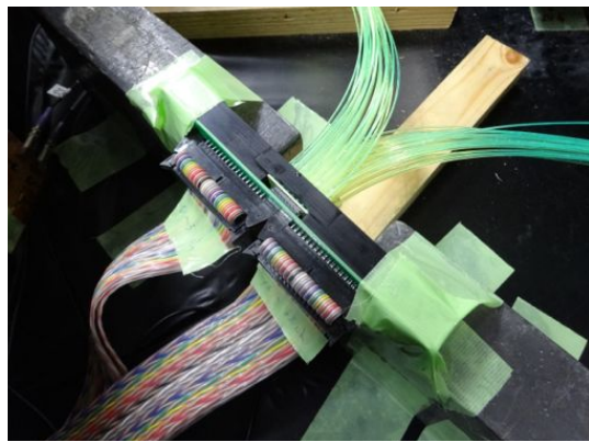
写図 8.3.12: 64ch array 型 MPPC とクッキーの接続の様子。写真は水槽下側のトリガーシンチレータ。
