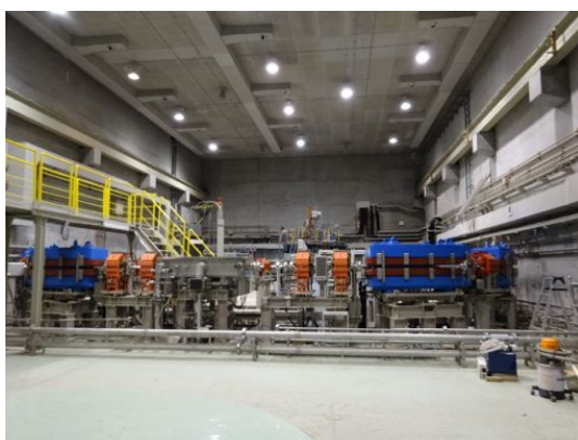
図 7.1.4: STB リング (側面図)。青い磁石が偏向電磁石で、赤い磁石が四重極電磁石である。
