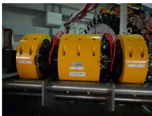
図 7.1.5: 三連四極電磁石。運動量選別用の鉛コリメータが真空パイプ中に埋め込まれている。
