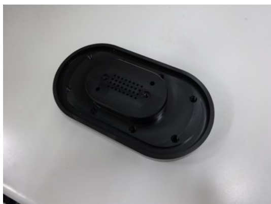
図 8.2.5: 32ch MPPC 用クッキー表面
