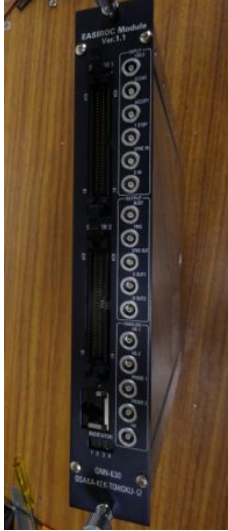
図 7.3.8: EASIROC module の前面写真
